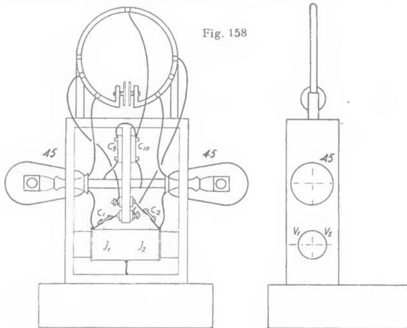
La lunghezza dell'onda emessa dipende dalle caratteristiche del circuito oscillatorio (diametro della spira e distanza fra le piastre). La modulazione viene effettuata col sistema Heising.
