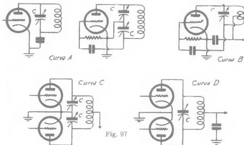
2° - L'inserzione della bobina di arresto deve provocare una diminuzione (se pur leggera) della frequenza del circuito oscillatorio e non un aumento. Ciò significa che la bobina deve avere l'effetto di una piccola capacità ammettendo un minimo passaggio di corrente di *AF* in anticipo sulla tensione. La causa di questo comportamento va cercata nel rapporto fra induttanza e capacità distribuita della bobina di arresto.
