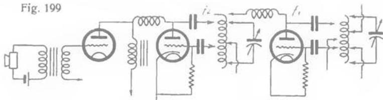
Ciò permette di modulare un oscillatore ad O.C. ( $f_1$ ) mediante una oscillazione ad onda lunga (modulata o no) ( $f_2$ )
