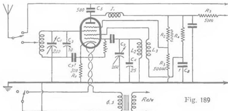
Sarebbe stato possibile, mediante l'adozione di condensatori variabili ad alta capacità, estendere la gamma delle onde ricevibili mantenendo una coppia di sole bobine fisse, ma per tenere quanto più elevato possibile il rapporto  $L:C$  che come si è detto ha tanta importanza nel circuito oscillatorio, si è preferito ricorrere alle induttanze intercambiabili le quali figurano in numero di tre e permettere di coprire tre gamme d'onde (11-33; 31-70; 65-145).
