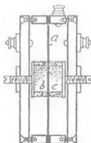
Di due microfoni a carbone identici in tutte le altre caratteristiche costruttive sarà più sensibile quello con polvere di grana più grossa e, a parità di intensità di suono, si otterranno in quest'ultimo maggiori variazioni di corrente.
