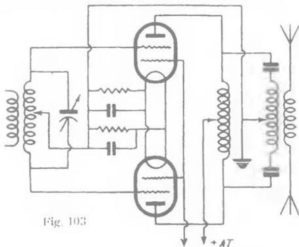
A tale scopo possono essere vantaggiosamente impiegati due tetrodi di potenza (per emettitori) a corna per *O.C.*
