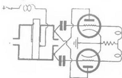
Se si allontanano le «valve» si ha un leggero aumento di induttanza ma una forte diminuzione della capacità esistente fra i bordi.
