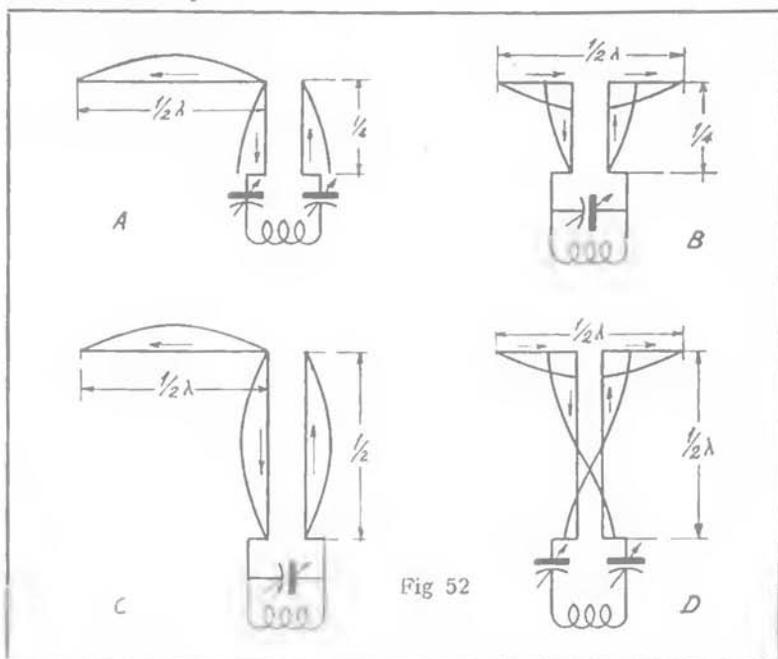
Con le discese risonanti è possibile alimentare per tensione un aereo di  $1/2$  onda collegandosi con un filo solo della discesa ad una delle estremità. La fig. 52 mette in evidenza l'andamento delle correnti nei diversi casi summenzionati e può fornire un criterio in merito alla scelta del sistema più adatto d'alimentazione nelle diverse condizioni di sistemazione dell'aereo.
