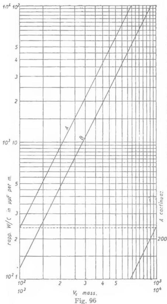
L'abaco di fig. 96 costituisce un utile complemento del precedente perchè fornisce con estrema facilità il valore di tensione ad *AF* che si forma ai capi del circuito oscillatorio.
