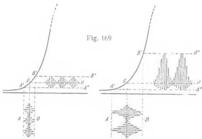
anche una forte dissimetria nell'amplificazione dei due semiperiodi con l'effetto di produrre variazioni di corrente anodica ad ogni variazione di ampiezza della oscillazione ad  $AF$  del segnale, cioè di dar luogo alla rivelazione del segnale stesso. Il sistema di rivelazione per caratteristica anodica non conferisce alla valvola rivelatrice una buona sensibilità perchè la fa lavorare in una zona poco favorevole della curva anodica.
