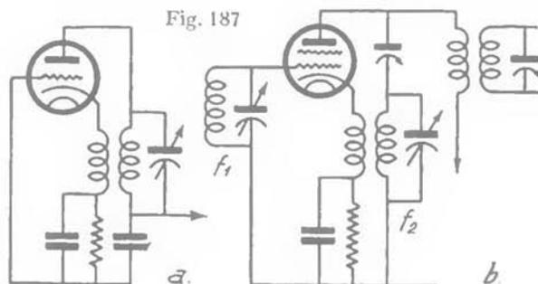
Se dunque (fig. 187 b) si applica fra la griglia e la massa un circuito oscillante percorso dalla corrente del segnale che si vuol ricevere, l'oscillazione di questo potrà venire regolarmente rivelata senza che per ciò abbia a risentire l'influenza della sezione oscillatrice.
