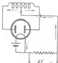
Infatti, se agli estremi della utilizzazione della corrente a frequenza doppia (che per semplicità è rappresentata da una resistenza) si forma una *f.e.m.* alternata, derivata o no da quella del circuito delle placche, questa darà luogo nei due rami esterni ad impulsi di corrente simultanei e diretti nel senso filamento-placche. Tali impulsi dovendo però percorrere il secondario del trasformatore di alimentazione per raggiungere le placche, ed essendo
